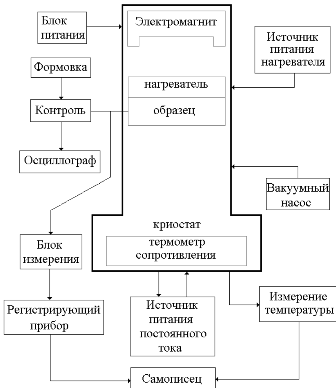
Рисунок 13 – Блок-схема установки для измерения электропроводности
