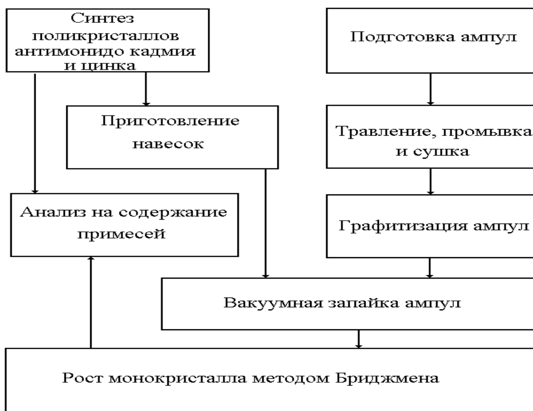
Рисунок 7 – Технологическая схема роста монокристаллов антимонидов кадмия и цинка
